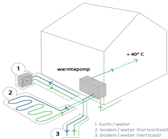
Als uw eenheid al goed geïsoleerd is en als u beschikt over oppervlakteverwarming of voldoende grote radiatoren, dan kunt u de plaatsing van een warmtepomp overwegen. Bij uw renovatie kunt u het best kiezen voor een systeem met een seizoensprestatiefactor (SPF) van 4 of hoger.
